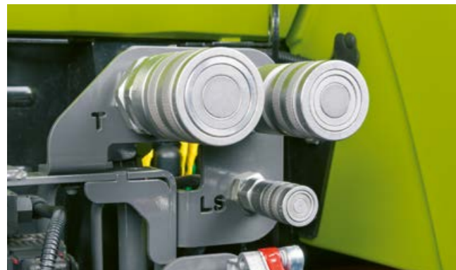
Für Anbaugeräte mit eigenen Steuereinheiten gibt es für den Load-Sensing-Kreislauf die Power-Beyond-Anschlüsse im Heck. Damit steuert das Anbaugerät seinen Ölbedarf selbst, ohne permanenten Ölumlaufl.
