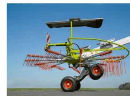
Große Aushubhöhe zum Überfahren von Schwaden am Vorgewende: bis zu 50 cm beim LINER 700 TWIN.
