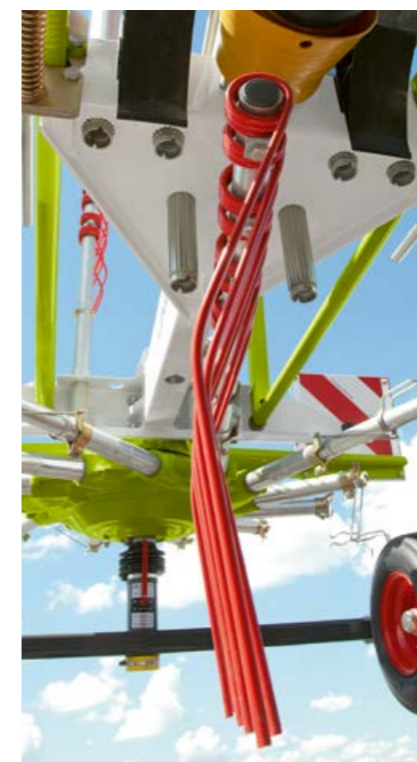
Die Standardzinken bei den Modellen 450, 420 und 370 sind mit ihren 9 mm extrem stabil und eignen sich sowohl für Heu als auch für Silage.
