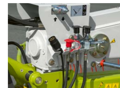
Serienmäßig hydraulische Folgesteuerung für zeitlichen Versatz zwischen vorderem und hinterem Kreis bei Ausheben und Absenken.
