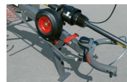
Die flexible Bügelanhängung mit Querpendelung ermöglicht Wendemanöver bis zu 80°.
