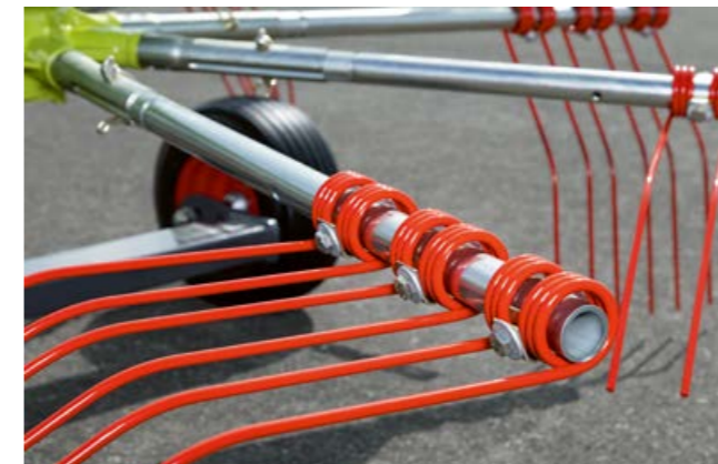
Werkzeuglose Abnahme der Zinkenträger.
