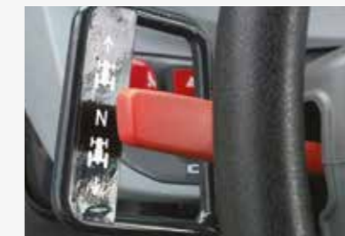
LASTSCHALTWENDEGETRIEBE AM LENKRAD das den Wechsel zwischen Vorwärts- und Rückwärtsfahrt ermöglicht, ohne dass die Kupplung betätigt werden muss
