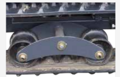
RAUPENKETTEN AUF DREHGESTELLEN MIT AUSGLEICHFEDERN
