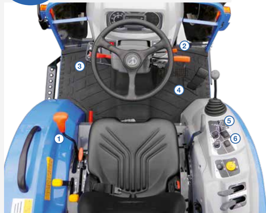
Gangwahlhebel (1), Hi-Low-Schaltung (2), Wendegetriebe (3), Fahrpedal (4), Geschwindigkeitsregler (5), Memory-Funktion, um zur ursprünglichen Geschwindigkeit zurückzukehren (6).
